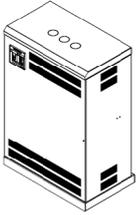
La batterie de condensateur Alpimatic type H est une batterie automatique à commutation par contacteurs électromécaniques. Elle est composée de plusieurs gradins. L'ensemble est piloté par le régulateur varmétrique ALPTEC.
