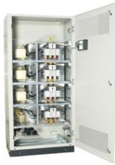
La batterie de condensateur Alpimatic type SAH est une batterie automatique à commutation par contacteurs électromécaniques. La MS.R48040.215 est composée de racks ALPIMATIC renforcé, avec selfs anti-harmoniques, type R7. L'ensemble est piloté par le régulateur varmétrique ALPTEC.
